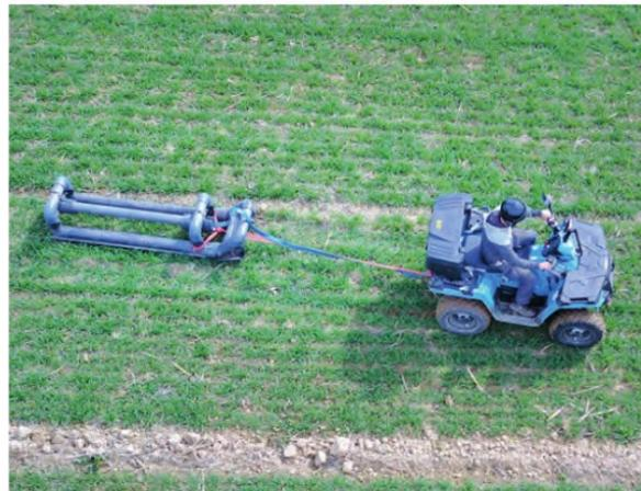
Foto 2. Equipo de medida de conductividad eléctrica aparente Dualem.
