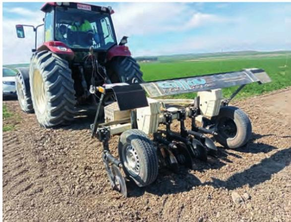
Foto 1. Equipo de medida de conductividad eléctrica aparente Veris.
